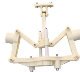
원심형 조속기가 내장되어 있어 웬 가 동시 회전력에 의해 개폐하도록 되어 있어 떨림방지 및 완전한 개방이 가능
